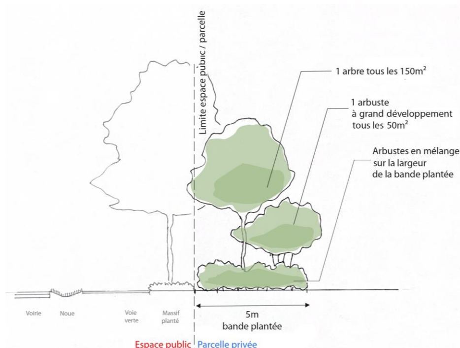
Schéma du traitement de la limite en lisière Est - Cas général d'absence de clôture
